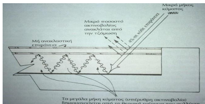
Σχήμα 6: Καθώς η ακτινοβολία προσπίπτει στον συλλέκτη συλλαμβάνεται από τον απορροφητήρα και μετατρέπεται σε ακτινοβολία μεγαλύτερου μήκους κύματος, η οποία δεν μπορεί να διέλθει εύκολα από την τζάμωση.
